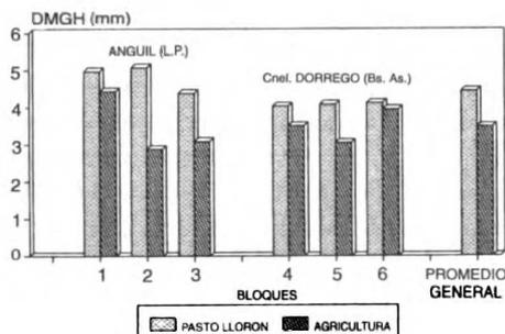
Figura 2: Diámetros medios geométricos de tamizado en húmedo (DMGH)
