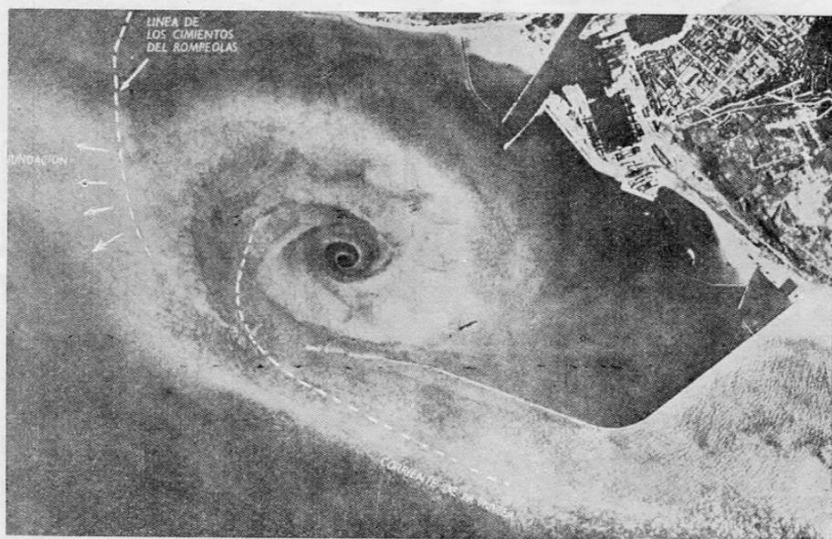
Fig. 8. — El puerto de Boulogne, durante las mareas más altas, mostrando el vórtice formado en la boca del puerto por el agua cargada de material en suspensión. Estas son fotografías comunes; pudo haberse obtenido mayor profundidad usando filtro verde en lugar de rojo. Con filtro verde se hace mejor la graduación de matices entre la costa y el negro del mar profundo.
