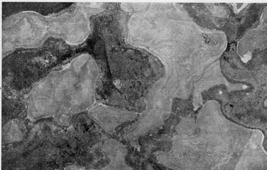
Fig. 3. — Fotografía aérea de una zona del paraje denominado «El Palenque», partido de General Lavalle — zona muy baja — con cota media más 2. Las partes más claras corresponden a superficies de tierra gris arcillosa firme. En cambio las superficies más oscuras corresponden a bañados con juncos.
