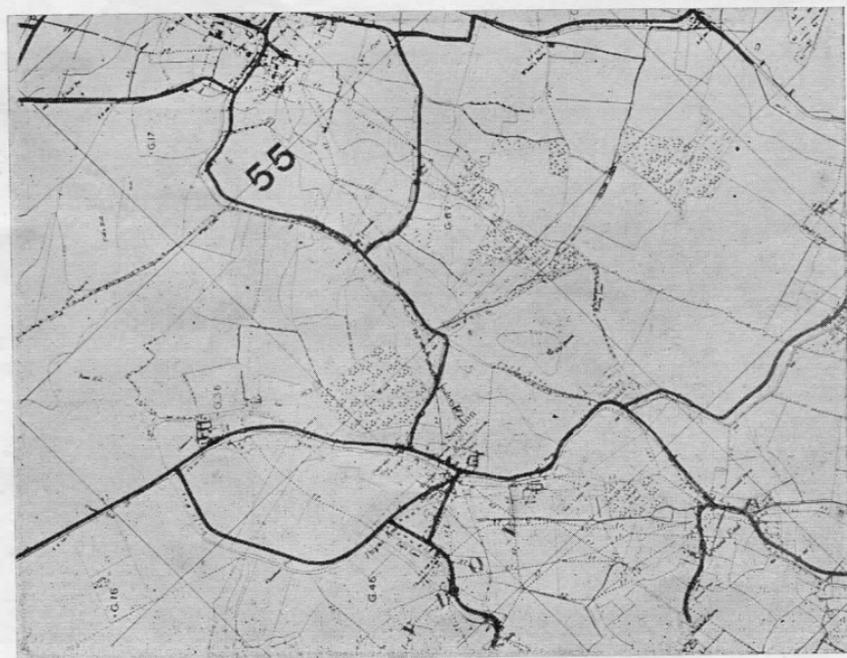
Fig. 10. — Comparación de las carreteras observadas en el mismo vuelo experimental controlado por radar, con las carreteras registradas por la fotografía de tierra (las carreteras delineadas por medio del radar están trazadas en negro).
