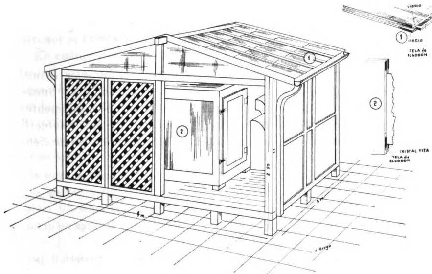
Fig. 7. — Cámara microclimática de cuatro metros cúbicos, con climatizador « Carrier » usada para la crianza artificial de pulgones destinados a los ensayos de resistencia. El armazón es de « viratón » con dobles cristales de cuarzo « vita », separados tres centímetros y tela blanca de algodón en el medio. Trabaja a temperatura constante de veinte grados centígrados.
