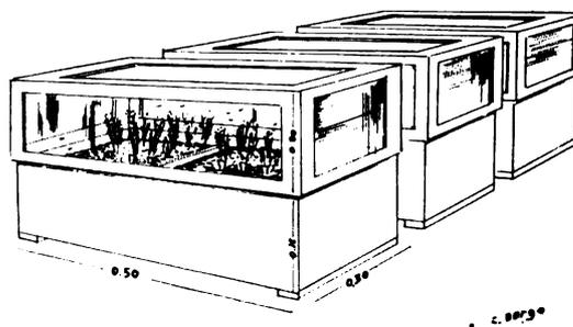
Fig. 6. — « Ensayo tipo » usado desde 1948 para las pruebas de resistencia. Cajones de madera dura con tapa de arcazón de cedro cubierto con doble tela de algodón y un frente de vidrio para las observaciones.
