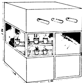
Fig. 1. — Primeros ensayos de resistencia de cereales (1944). Jaula de hierro y tela metálica, malla 100, para crianza artificial de pulgones.
