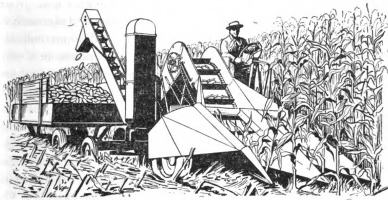
Fig. 26. — Espigadora automotriz trabajando
